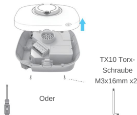
TX10 Torx-Schraubendreher (Drehmoment: 0,8Nm)
